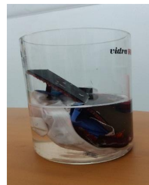
Fotos 5 y 6: Inmersión de las probetas 24 horas
