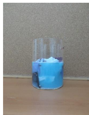
Fotos 5 y 6: Inmersión de las probetas 24 horas
